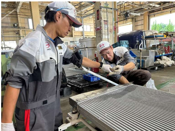
↑レース車両用の特注インタークーラーを搭載
