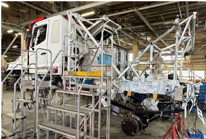
↑キャブ、燃料タンク、リアアスルが搭載され、車っぽくなってきましたね！
