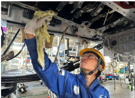
介レース車専用のオイルパンへ換装するため、入念に清掃する福田メカ
